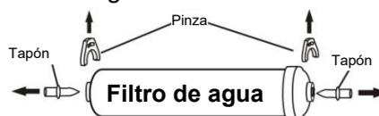
2) Inserte completamente el tubo de 1/4" en la entrada del filtro de agua.
