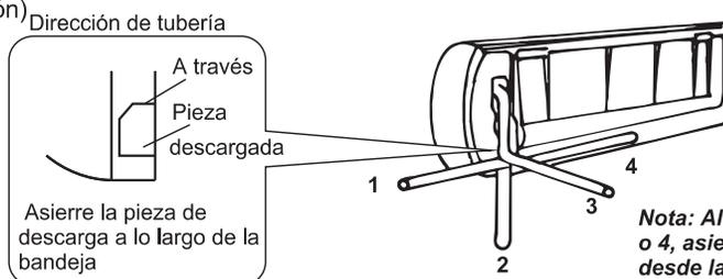
**Nota:** Al instalar la tubería en las direcciones 1, 2, o 4, asierre la pieza descargada correspondiente desde la base de la unidad interna.
